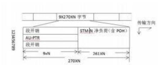
整个帧结构分为3个区域——段开销（SOH）区、信息净负荷区和管理单元指针。段开销（SOH）是指SDH帧结构中，为了保证信息正常传送而供网络运行、管理和维护所使用的附加字节。信息净负荷区域内存放的是有效传输信息。管理单元指针实际上是一组数码，用来指示净负荷中信息起始字节的位置。
